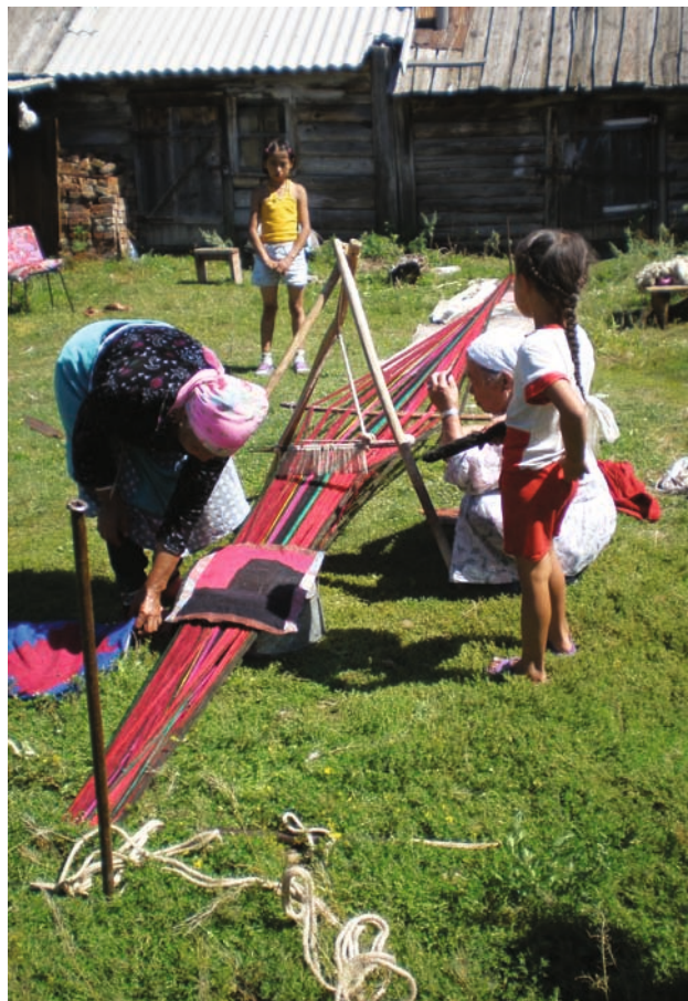
Рис. 8. Общий вид горизонтального ткацкого станка с основоразделителем для изготовления ковров-алаша
